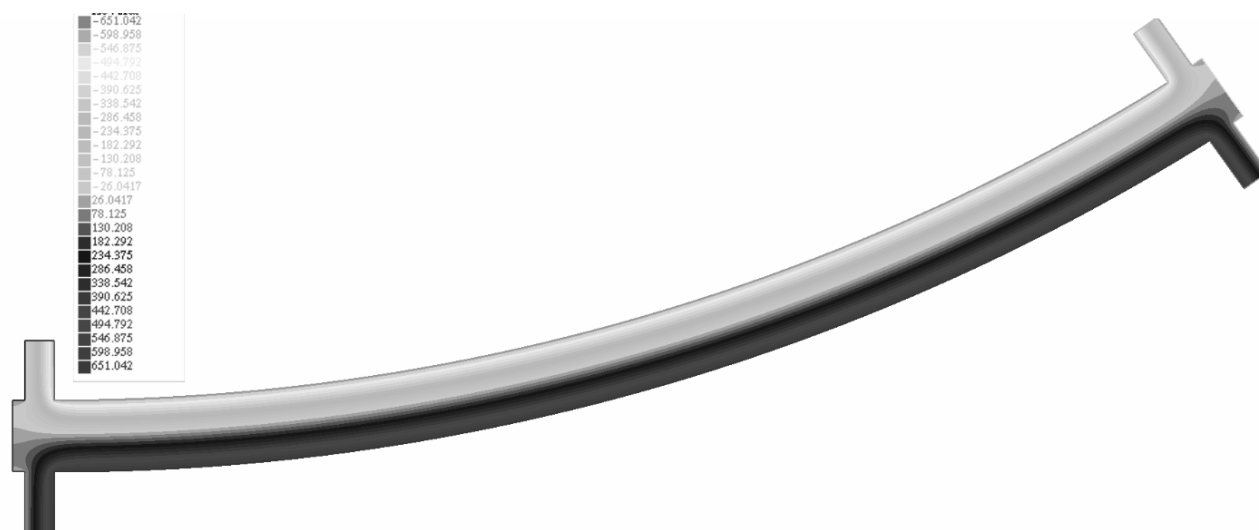
Рис. 4. Распределение потенциала в электростатическом анализаторе
