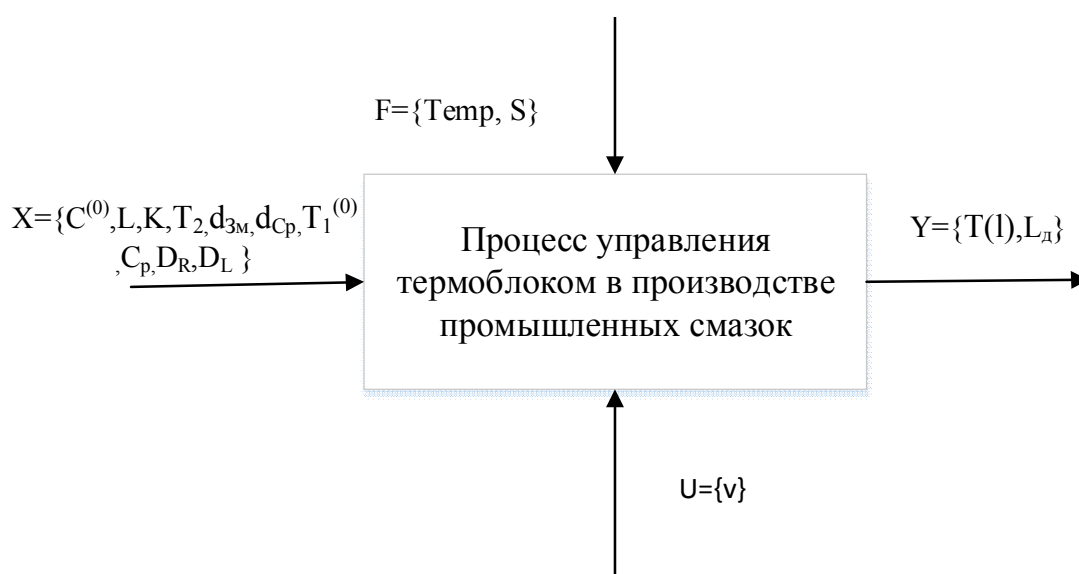
Рис. 1. Формализованное описание процесса термообработки как объекта управления
