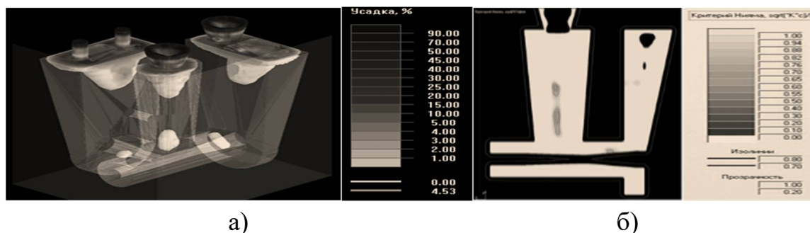
Рис. 3. Усадка и пористость, выявленные в детали по расчетам: а) усадка; б) пористость
