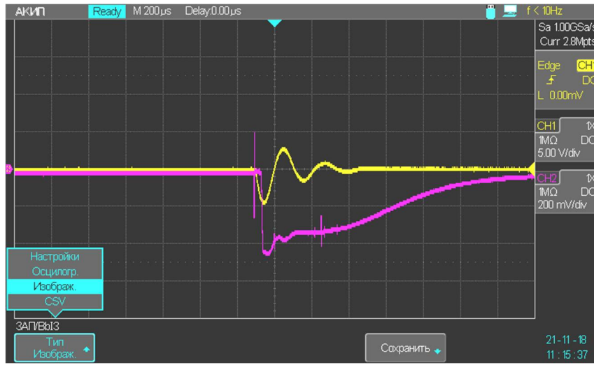
Рис. 2. Синхронные осциллограммы высоковольтного импульса тока (желтый цвет) и яркостной температуры поверхности (фиолетовый цвет) консолидируемого порошкового образца
