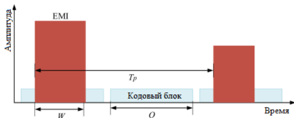
Рис. 6. Пример случая, когда повторяющийся цикл T_p намного больше длины блока кода Q
