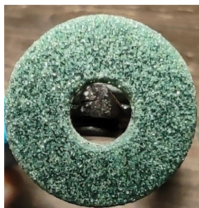
Рис. 4. Напечатанный образец шлифовального круга из фотополимер-абразивного композита
