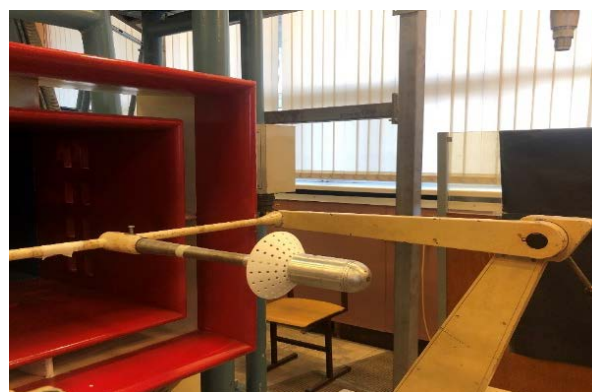
Рис. 3. Экспериментальная модель с полусферическим затуплением и перфорированной юбкой в рабочей части аэродинамической трубы
