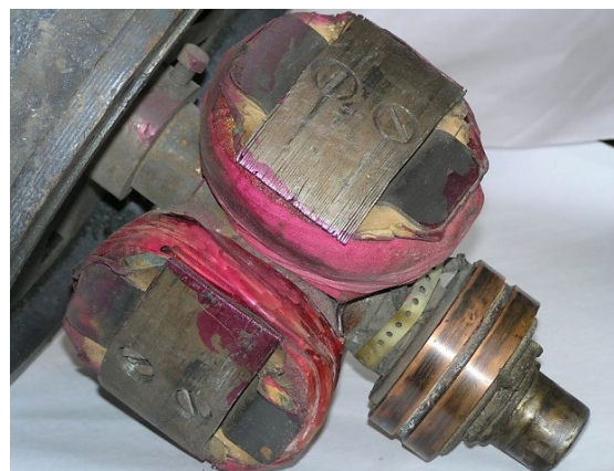
Рис. 1. Ротор четырехполюсного синхронного генератора СГР-4,5
