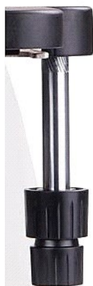
Рис. 4. Общий вид ручки управления предметным столиком прибора оптического контроля
