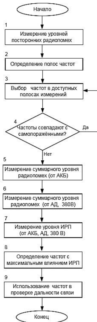
Рис. 1. Блок-схема проведения испытаний на оценку влияния ИРП в трактах РПУ РЭС
