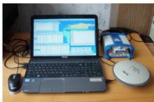
Рис. 2. Состав аппаратно-программного комплекса мониторинга состояния ионосферы
