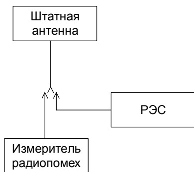
Рис. 2. Схема измерения посторонних радиопомех, принимаемых штатными антеннами РЭС
