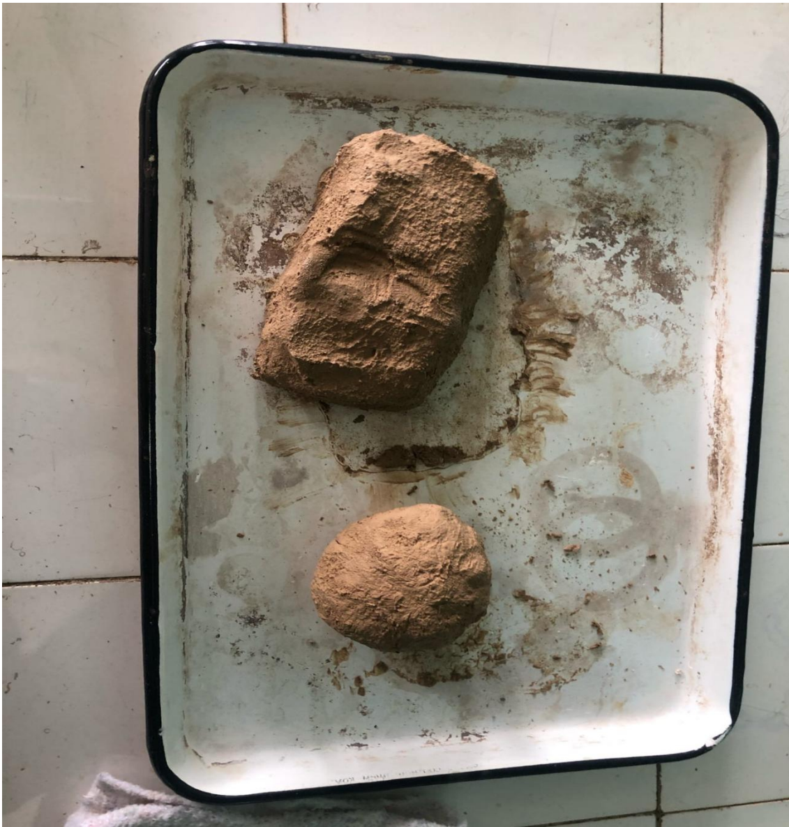
Рис. 4. Образцы глины после нагревания в термической камере
