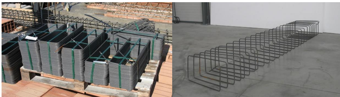
Рис. 1. Хомуты-спирали, изготовленные на станке по технологии «Spirex»
