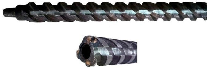
Рис. 8. Физическая картина улучшенной бурильной трубы с канавками
