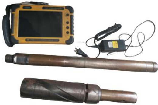
Рис. 3. Прибор для измерения траектории бурения YZG6.4
